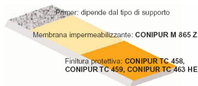
Figura 1. Stratigrafia di CONIROOF 2160
