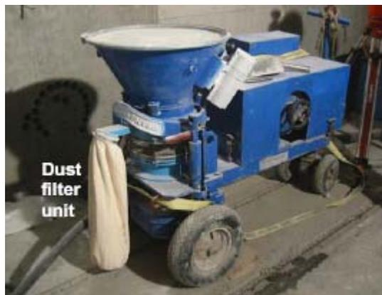
Il riempimento della tramoggia della pompa con il prodotto secco deve essere eseguito con cura evitando di creare polvere in eccesso. Il pavimento circostante alla pompa deve essere bagnato con acqua durante l'applicazione.
