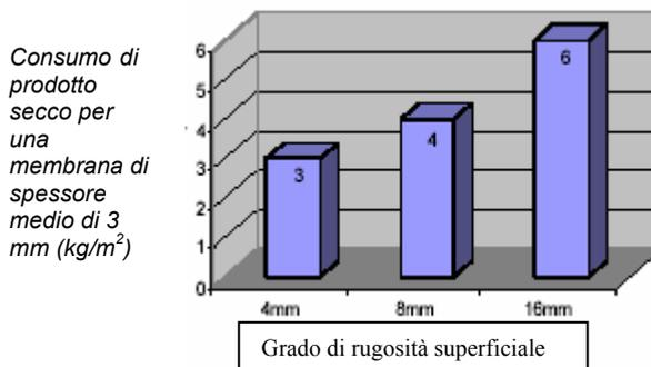
Se la rugosità della superficie del supporto richiede più di  $6 \text{ kg/m}^2$  di MASTERSEAL 345, si può pensare di eseguire una lisciatura applicando un leggero strato di malta cementizia (con  $\varnothing$  max inerte di 4 mm). Il consumo del MASTERSEAL 345 è fortemente influenzato dal grado di rugosità della superficie del supporto.
