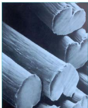
Foto 3: Fibra RICEM al microscopio
