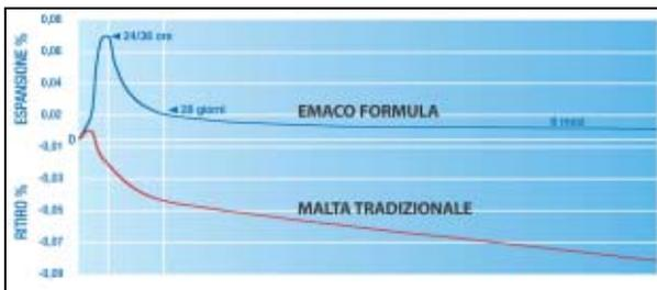
L' EMACO FORMULA FLOWFIBER, sottoposto al test di inarcamento/imbarcamento, evidenzia già dopo 24 ore un inarcamento (∩) del provino che dimostra, in modo semplice ed immediato, l'effettiva capacità del prodotto di garantire espansione contrastata in aria.
