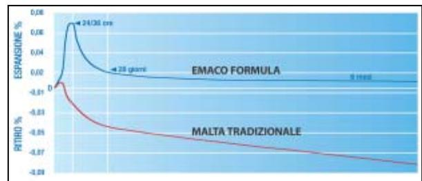
L' EMACO S150 CFR, sottoposto al test di inarcamento/imbarcamento, evidenzia già dopo 24 ore un inarcamento (∩) del provino che dimostra, in modo semplice ed immediato, l'effettiva capacità del prodotto di garantire espansione contrastata in aria
