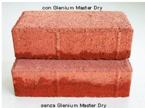
**Foto 1 : Assorbimento d'acqua in masselli per pavimentazione, senza e con Glenium Master Dry**
