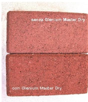
**Foto 3 : Pigmentazione di masselli per pavimentazione, senza e con Glenium Master Dry**
