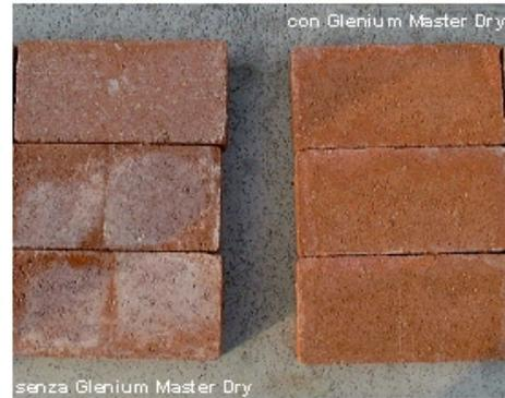
**Foto 2 : Formazione di efflorescenze in masselli per pavimentazione, senza e con Glenium Master Dry**
