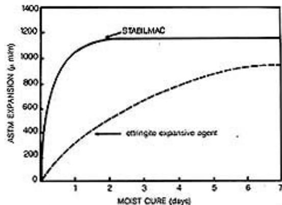
Fig. 1 Influenza della stagionatura sull'espansione contrastata con agenti espansivi diversi. (Cemento CEM i 425 = 300 kg/m<sup>3</sup>, acqua - 180 l/m<sup>3</sup> agente espansivo = 30 kg/m<sup>3</sup>; inerti = 1900 kg/m<sup>3</sup>).
